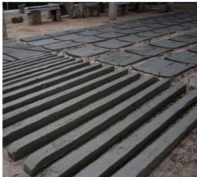
Figura 29, 30, 31: Placas laterales, vigas y placas del techo (06/07/19) Fuente: Registros del Colectivo La Jarilla
