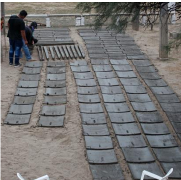
Figura 29, 30, 31: Placas laterales, vigas y placas del techo (06/07/19) Fuente: Registros del Colectivo La Jarilla
