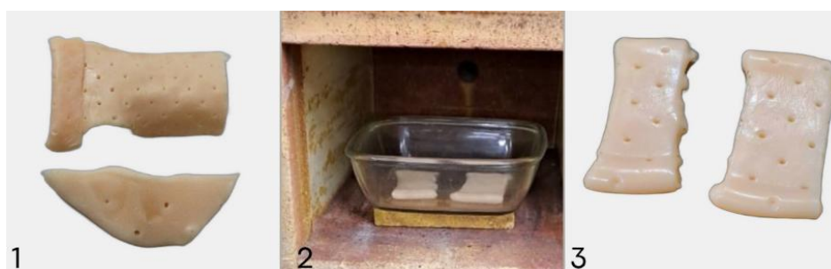
Figura 17: proceso de tratamiento térmico del termoplástico de baja temperatura ORFIT© en estado de vencimiento.
