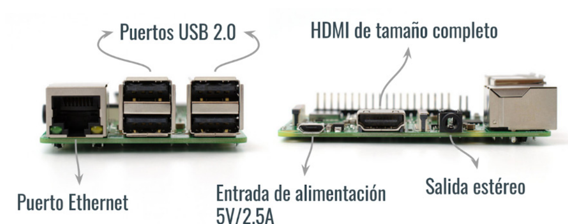
Figura 1. Puertos de Entrada-Salida que componen a la Raspberry Pi.
