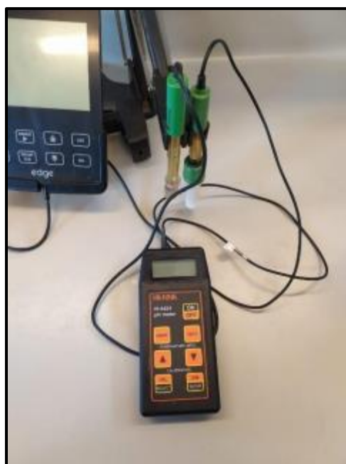
Figura 19. pH-metro electrónico HANNA HI 8424
