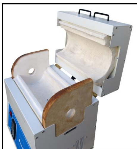
Figura 22. Estufa tubular (T- 150, INDEF).
