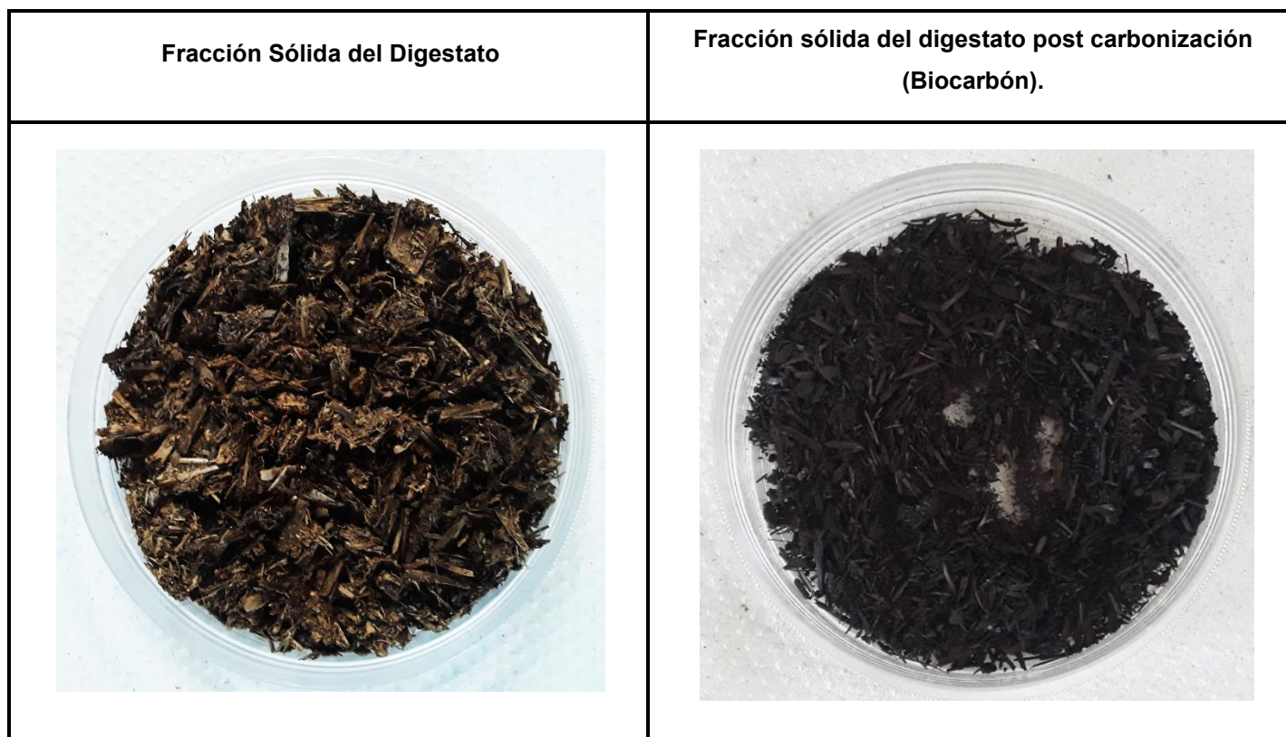
Figura 11. Digestatos y Biocarbones Fuente: Elaboración propia.
