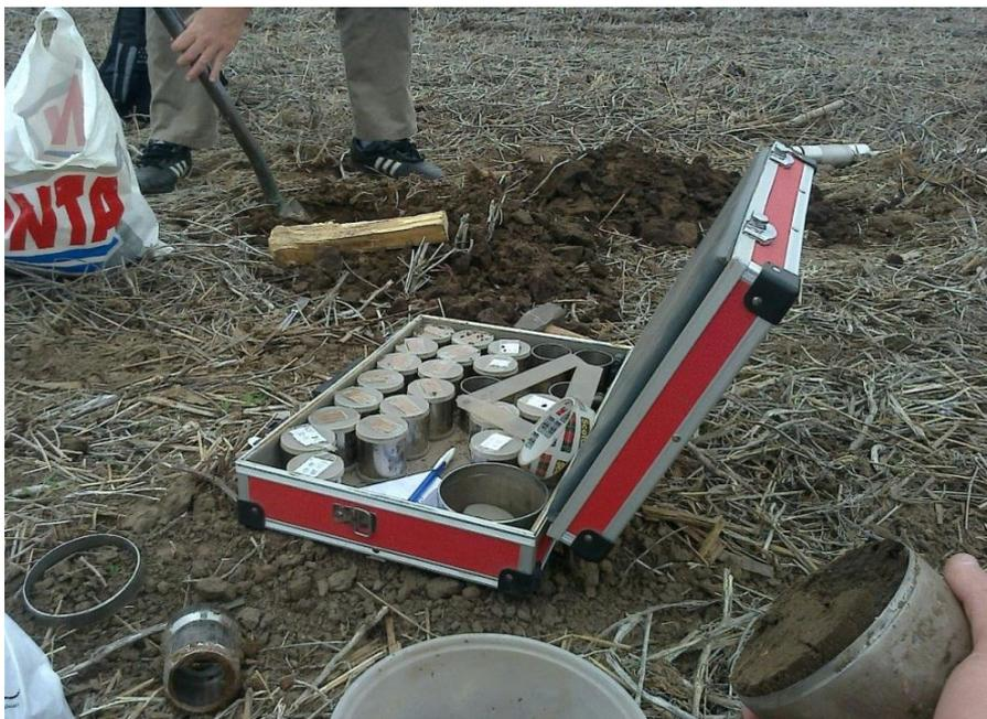
**Figura 1.** Imagen de cilindros de  $100 \text{ cm}^3$  de volumen utilizados para la medición de Dap en diferentes profundidades.
