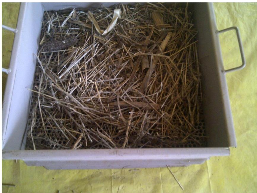
**Figura 4.** Imagen de tamiz utilizado para separar el rastrojo muestreado de resto de suelo.
