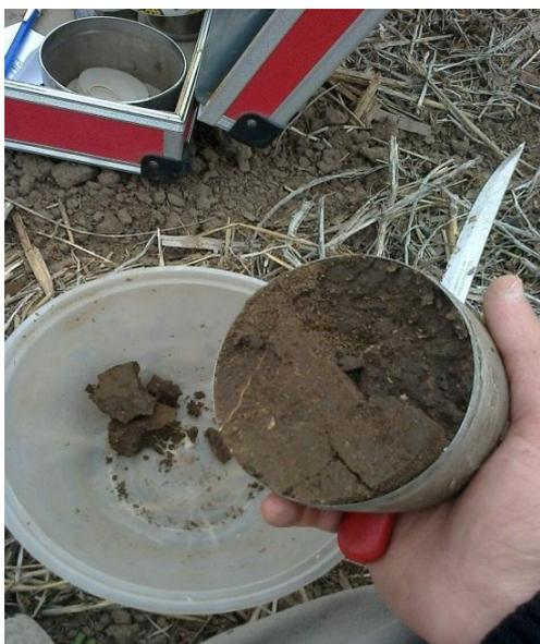
**Figura 2.** Imagen de cilindro utilizado para la toma de muestra compuesta sin disturbar.
