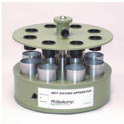
**Figura 2.** Imagen del equipo utilizado para medir estabilidad de agregados por el método de Kemper y Rosenau (1986).
