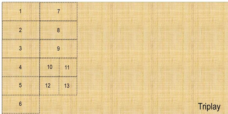
Figura 5: Estimación de madera en lámina de Triplay
