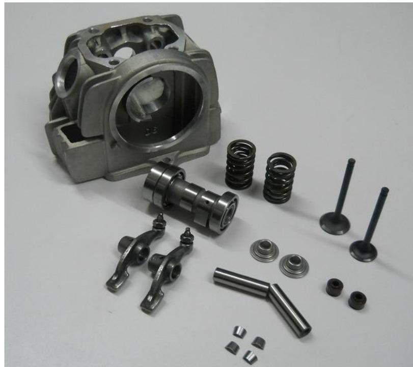
Tapa de cilindro de moto con sus componentes
