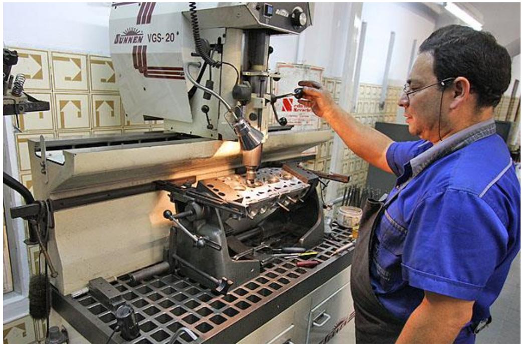
Rectificadora de asientos de válvulas de tapa de cilindros
