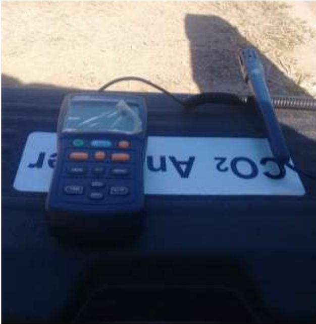
**Figura 15.** Medidor “thermo-hygro-ndir
